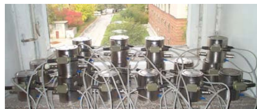
Гидростатические датчики уровня перед отправкой в SLAC
