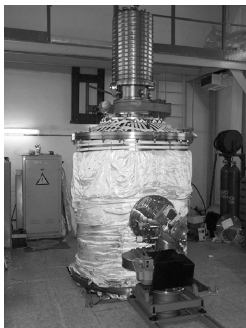
Рис. 9. Вакуумный объем и криогенный насос тандема
