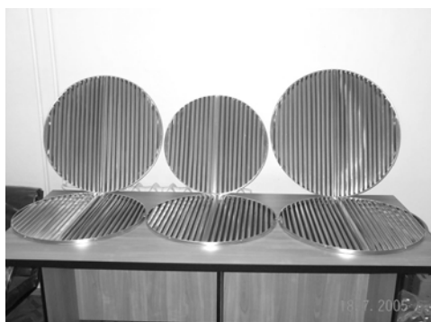
Рис. 8. Жалюзи электродов ускоряющих зазоров
