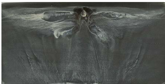
Рис. 9. Присоединенное течение после установки одного конического выступа. Срыв потока удалось устранить. По обеим сторонам от выступа образовался отрывной пузырь со сложным вихревым течением внутри него
