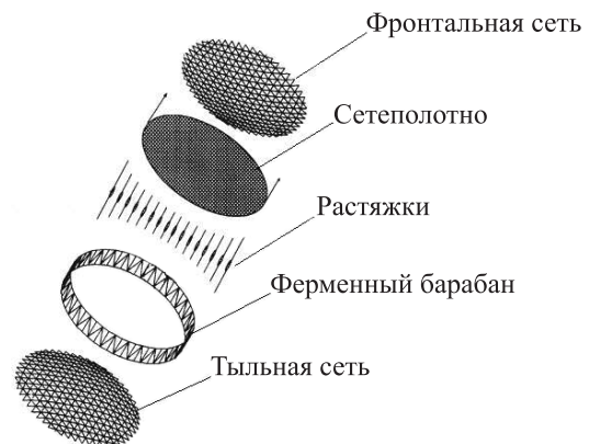
Рис. 2. Основные компоненты конструкции рефлектора
