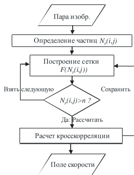
Рис. 5. Схема алгоритма фильтрации векторов скорости по локальной концентрации частиц
