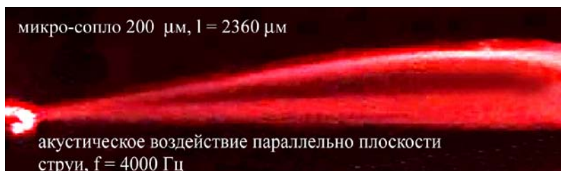
Рис. 16. Картина дымовой визуализации течения псевдоплоской микроструи при акустическом воздействии ( F = 4\,000 Гц)
