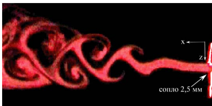
Рис. 11. Картина дымовой визуализации процесса развития плоской струи, истекающей из сопла шириной выходной щели 2,5 мм, под воздействием поперечного акустического поля ( F = 100 Гц)
