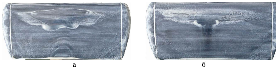
Рис. 14. Сажемастная визуализация при L = 300 мм: а – след за нитью отсутствует; б – след за нитью присутствует
