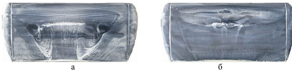
Рис. 12. Сажемастная визуализация при L = 120 мм: а – след за нитью отсутствует; б – след за нитью присутствует
