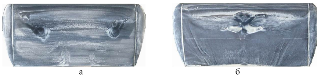
Рис. 11. Сажемастная визуализация при L = 50 мм: а – след за нитью отсутствует; б – след за нитью присутствует
