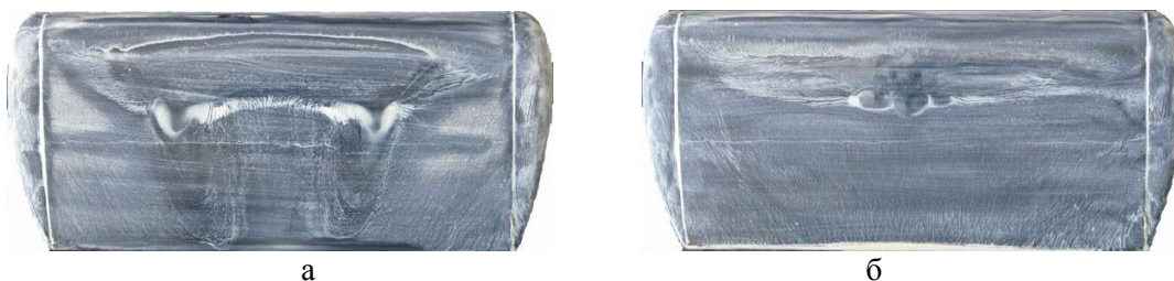
Рис. 13. Сажемастная визуализация при L = 220 мм: а – след за нитью отсутствует; б – след за нитью присутствует
