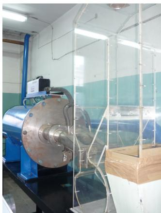
Рис. 2. Экспериментальный стенд для исследования аэродинамики модели топки ПВТ: 1 – модель вихревой топки; 2 – клапан; 3 – регулятор давления (редуктор); 4 – манометр; 5 – ресивер (для сглаживания пульсаций давления); 6 – дымогенератор XLINE FOG 800; 7 – автоматизированный измерительный комплекс ЛАД-05
