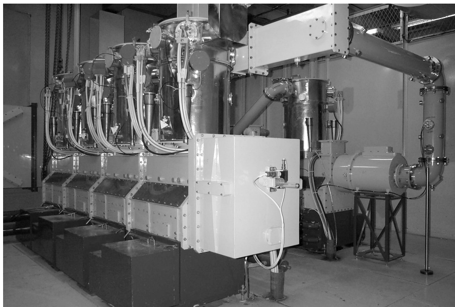
Рис. 6. Каскад с четырьмя ламповыми модулями
