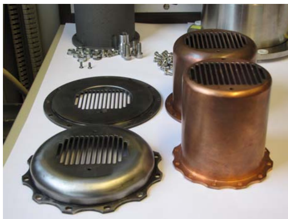
Рис. 11. Высоковольтные электроды щелевой ИОС
