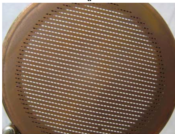
Рис. 9. Фотографии исходной составной подложки до напыления медного подслоя (а) и изготовленной медной ММС, закрепленной гальванически на опорном кольце (б)
