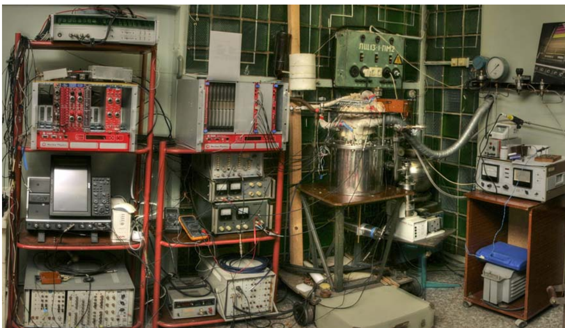
Рис. 4. Фотография экспериментальной установки. Показан двухфазный КЛД с криогенной камерой объемом 9 л, часть криогенной и вакуумной систем, электроника систем высокого напряжения и сбора данных
