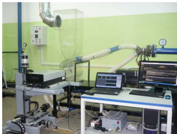
Рис. 2. Экспериментальный стенд для исследования аэродинамики в модели вихревой топки
