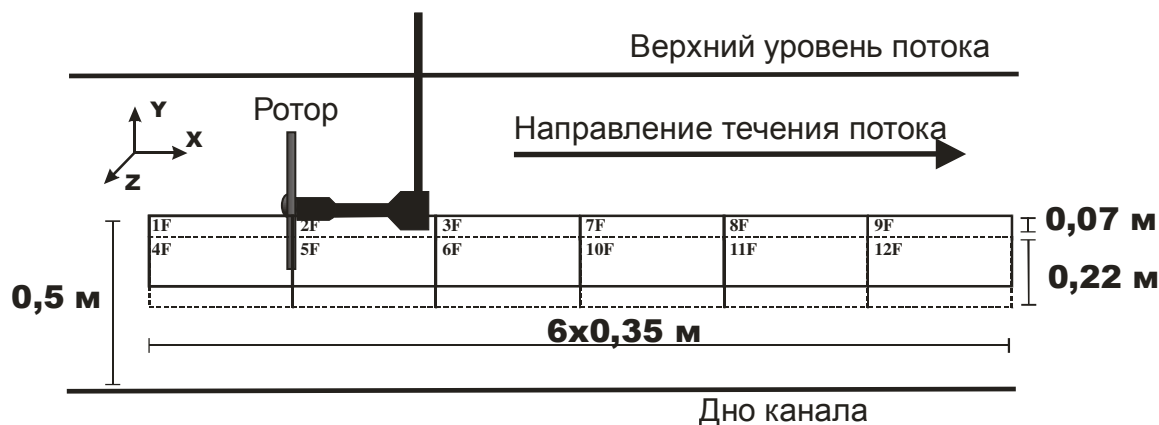
Рис. 2. Схема установки ротора и 12 измерительных окон в сечении лазерного ножа для 3D PIV-диагностики
