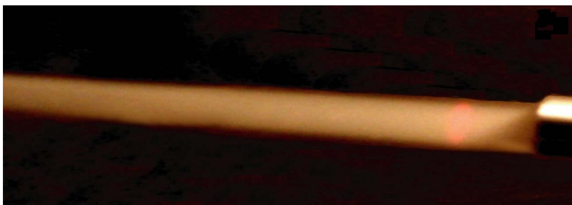
Рис. 2. Картина дымовой визуализации струи вдоль потока, скорость потока на оси струи, U_0 = 3 м/с ( Re_R = U_0 \times R / \nu = 2000 )
