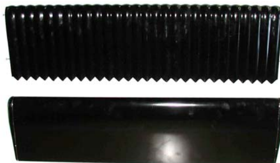
Рис. 6. Модели гладкого и волнистого крыльев (профиль Z-15-25, \lambda = 3,7 )
