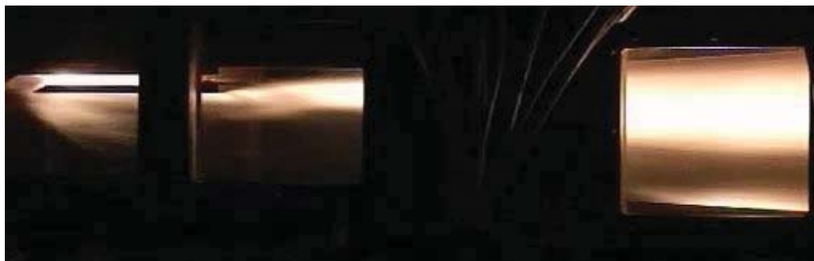
Рис. 15. Горение водорода в эксперименте ( M_{вх} = 5,8 , с геометрическим горлом)
