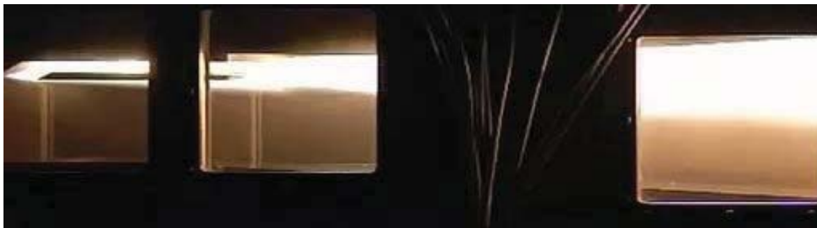
Рис. 12. Горение водорода в эксперименте ( M_{\text{вх}} = 5,8 , без геометрического горла)
