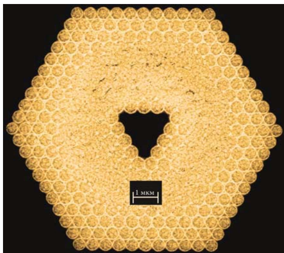
Рис. 2. СЭМ-изображение маски 2D ФК, полученной в резисте РММА на кремнии, демонстрирующее влияние эффекта близости
