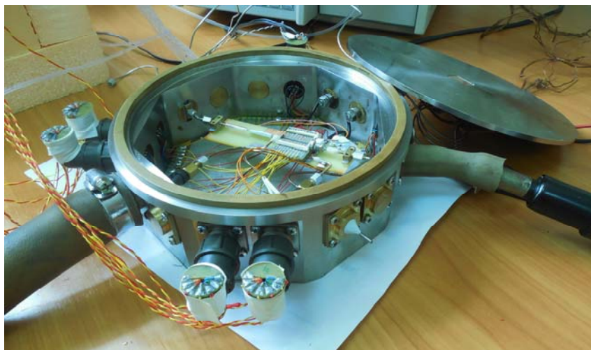
Рис. 1. Экспериментальный стенд. Вакуумная камера с рабочим участком
