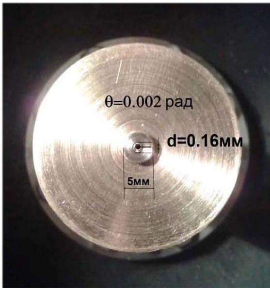
Рис. 9. Медный диск, на котором размещалась лавсановая пленка для регистрации положения центра пучка электронов, прошедших в датчик углового разброса через входной коллиматор. Центр диска отмечен отверстием диаметром 0,16 мм, которое на изображении выглядит черным кружком
