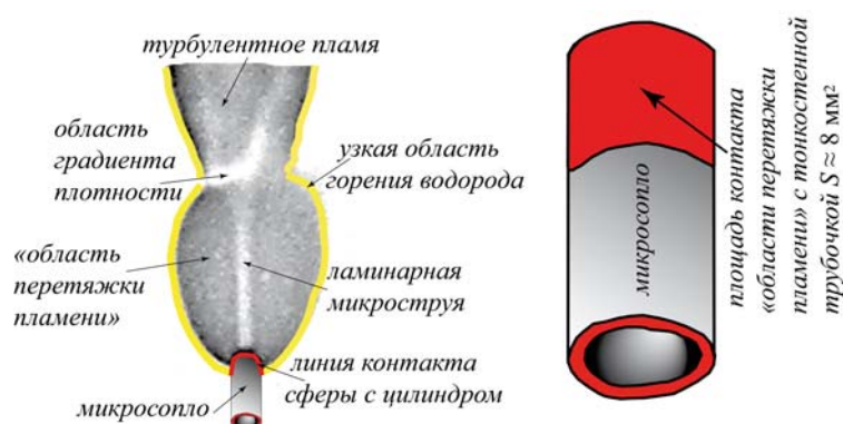
Рис. 15. Картина диффузионного горения круглой микроструи водорода, истекающей из микро-сопла с параболическим профилем скорости на его срезе (слева) и эскиз площади контакта ( S \approx 8 \text{ мм}^2 ) области перетяжки пламени с тонкостенной трубкой диаметром 0,6 мм (справа) [7]
