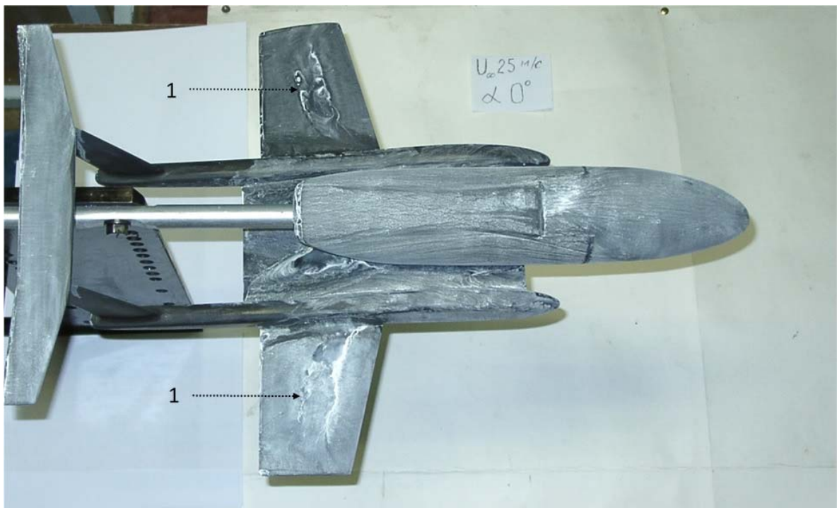
Рис. 2 (фото). Визуализация обтекания модели экраноплана Угол атаки \alpha = 0^\circ , скорость набегающего потока U_\infty = 25 \text{ м/с} (1 – ламинарно-отрывные пузыри)
