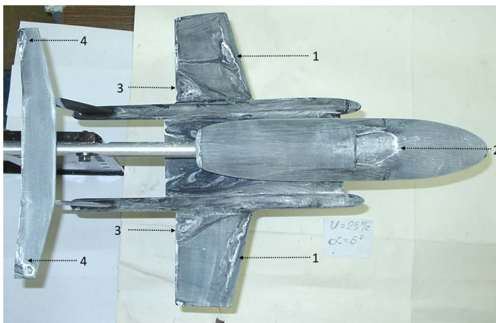
Рис. 6 (фото). Картина течения при угле атаки \alpha = 6^\circ (вид сверху): 1 – ламинарно-отрывные пузыри; 2 – ламинарный отрыв на верхней части фюзеляжа; 3 – отрывно-вихревые зоны; 4 – вихри при отрыве турбулентного пограничного слоя
