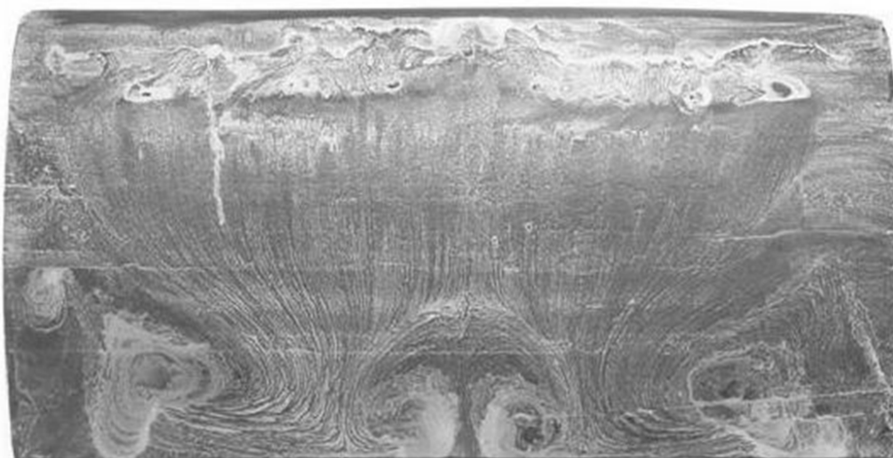
Рис. 5 (фото). Отрыв турбулентного пограничного слоя на модели прямого крыла (из работы [1]). Вид сверху
