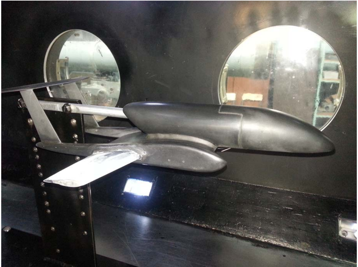
Рис. 1 (фото). Модель на державке в рабочей части аэродинамической трубы Т-324
