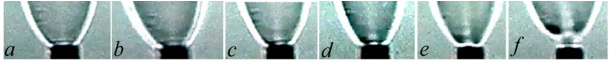
Рис. 5. Теневые картины развития пламени при диффузионном горении микроструи водорода (зажигание вдали от среза сопла), истекающей из сверхзвукового квазимикросопла Лавала 3 в зависимости от объемного расхода газа ( Q , \text{см}^3/\text{с} ): a - 50 , b - 60 , c - 70 , d - 80 , e - 90 , f - 100 (или скорости истечения микроструи, рассчитанной как U = Q/S : 1 923, 2 308, 2 692, 3 077, 3 461, 3 846 м/с соответственно)
