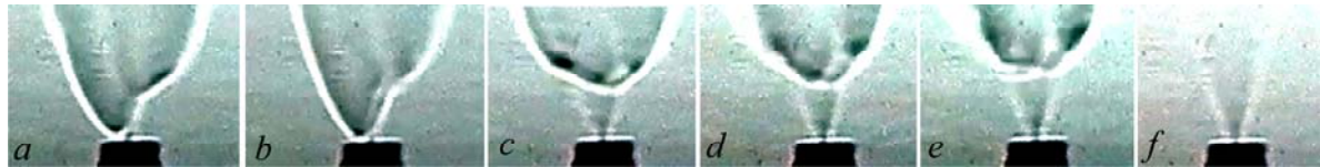
Рис. 6. Теневые картины развития пламени при диффузионном горении микроструи водорода (зажигание вдали от среза сопла), истекающей из сверхзвукового квазимикросопла Лавала 4 в зависимости от объемного расхода газа ( Q , \text{см}^3/\text{с} ): a - 150 , b - 160 , c - 170 , d - 180 , e - 190 , f - 195 (или скорости истечения микроструи, рассчитанной как U = Q/S : 1 685, 1 798, 1 910, 2 022, 2 135, 2 191 м/с соответственно)
