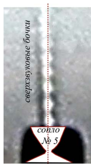
Рис. 13. Теневая картина наличия сверхзвуковых бочек при сверхзвуковом истечении круглой микроструи метана в отсутствие горения
