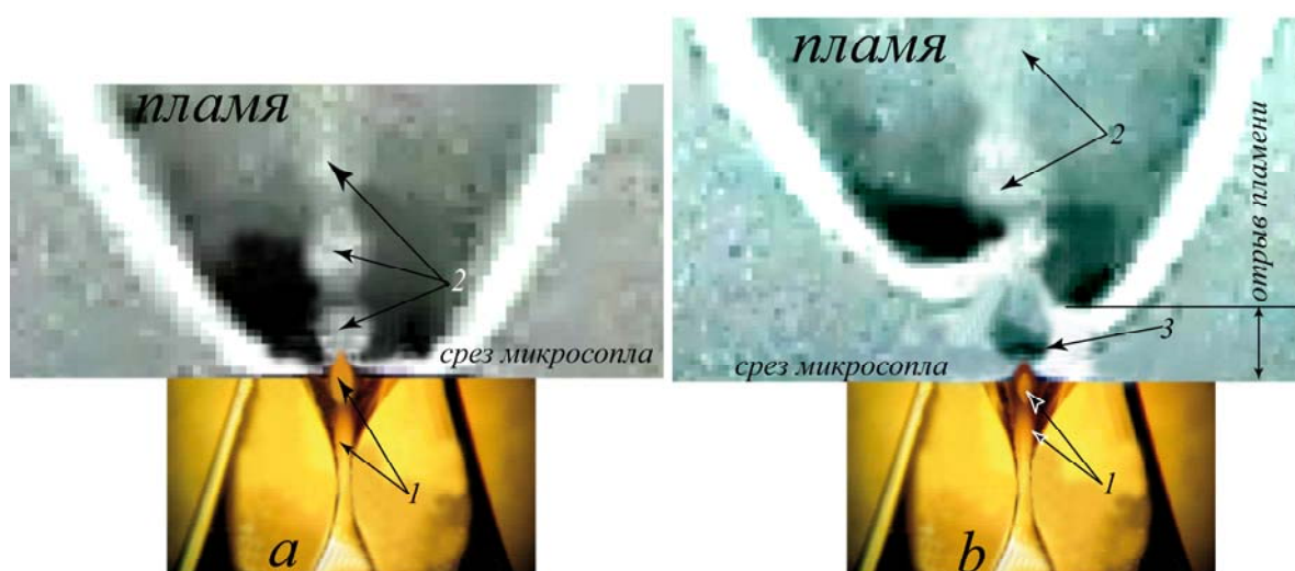
Рис. 8. Предполагаемая схема развития пламени при диффузионном горении микроструи водорода, истекающей из сверхзвукового квазимикросопла Лавалья 3, в ситуации ее зажигания вдали от среза сопла и при отрыве пламени вблизи (а) и вдали (б) от среза сопла: сверхзвуковые бочки внутри микросопла (1), внутри пламени (2) и в области отрыва пламени (3)
