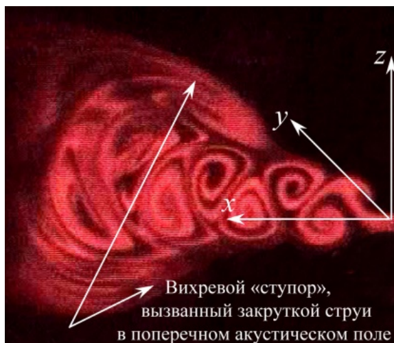
Рис. 14. Картина дымовой визуализации процесса развития плоской микроструи в поперечном акустическом поле ( f = 100 Гц)
