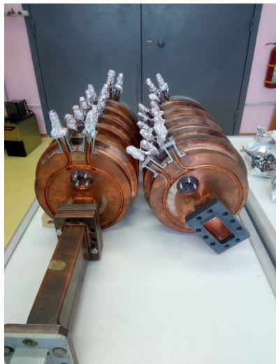
Рис. 5. Изготовленные резонаторы SLED
