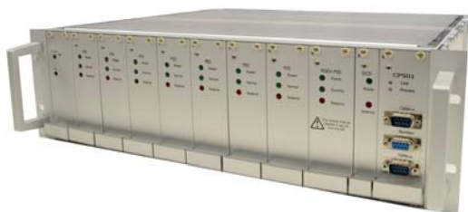
Рис. 3. Крейт системы «горячего» резервирования
