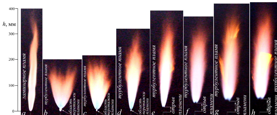
Рис. 2. Фотографии пламени при диффузионном горении микроструи водорода, истекающей из плоского ( l = 2,45 мм, h = 0,37 мм) микросопла в ситуации нарастания скорости ее истечения: a-h – значение U_0 от 40 до 1340 м/с, вид с узкой ( h ) стороны микросопла
