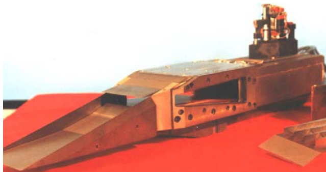
Рис. 2. Фото модели плоского воздухозаборника
