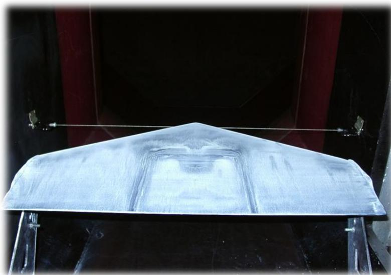
Рис. 1. Трапецевидная модель БПЛА
