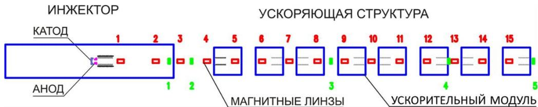
Рис. 1. Схема линейного индукционного ускорителя на энергию  $E_e = 5$  МэВ. Синим цветом показаны корпуса ускорительных модулей и инжектора, красным – фокусирующие магнитные линзы, зеленым – датчики положения пучка в канале транспортировки, серым – ускорительные трубки
