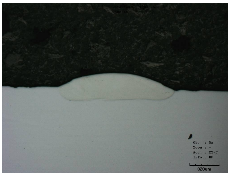
Рис. 2. Фотография шлифа поперечного сечения единичного трека Fig. 2. Photo of the cross-section cut of the single track
