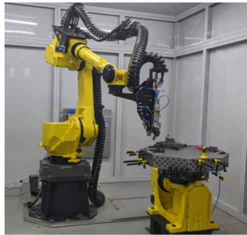
Рис. 4. Лазерный комплекс для аддитивных технологий
