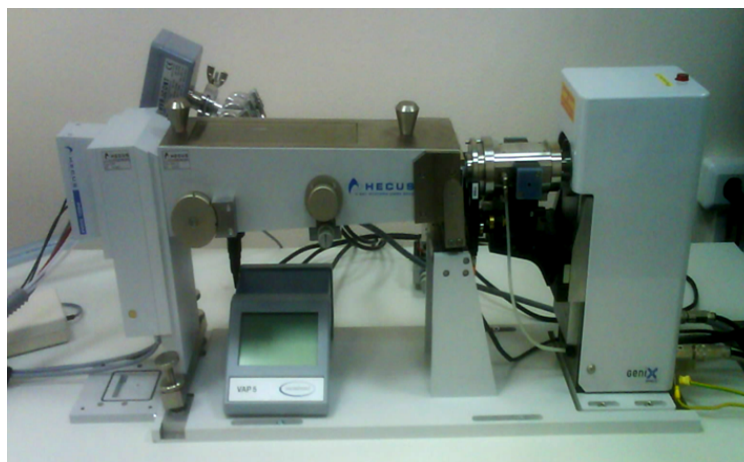
Рис. 8. Фотография малоуглового рентгеновского дифрактометра S3 Micro фирмы Hecus Fig. 8. Photograph of a small-angle X-ray diffractometer (SAXS) Hecus S3 Micro
