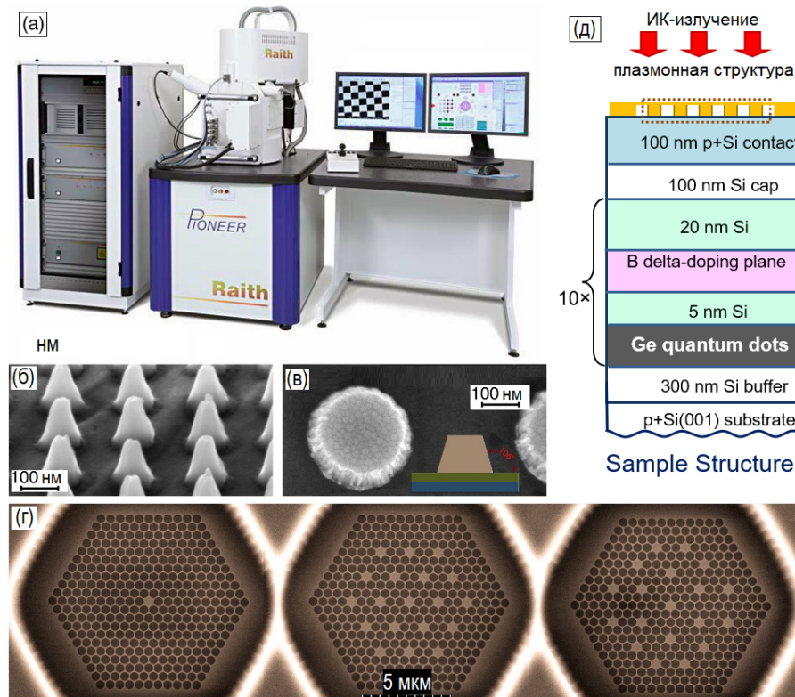
Рис. 7. (а) Установка Pioneer (RAITH) и РЭМ изображения двумерных регулярных структур Ge, выращенных и визуализированных с ее помощью: (б) конусообразные, (в) в форме диска; (г) двумерный фотонный кристалл, см. шкалу 5 мкм внизу; (д) гетероструктура образца с квантовыми точками Ge с перфорированной пленкой золота на поверхности Fig. 7. (a) Pioneer lithography apparatus (RAITH) and SEM images of two-dimensional regular Ge structures grown and visualized with its help: (b) cone-shaped, (c) disk-shaped. (g) 2D photonic crystal, see 5 μm scale below. (d) Heterostructures of a sample with Ge quantum dots with a perforated gold film on the surface
